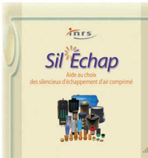
Les silencieux d'échappement permettent d'obtenir des gains de 20 à 40 dB(A). En dehors des critères acoustiques et de coût, ils se choisissent en fonction de la perte de charge qu'ils génèrent et de la facilité de leur maintenance (\*).
