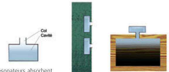
Les résonateurs absorbent des gammes de fréquences étroites en basses fréquences.
