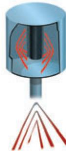
**Les silencieux de détente** : ils assurent une diminution de pression progressive au travers d'un dispositif poreux ; ils sont utilisés sur des évacuations d'air comprimé, par exemple.
